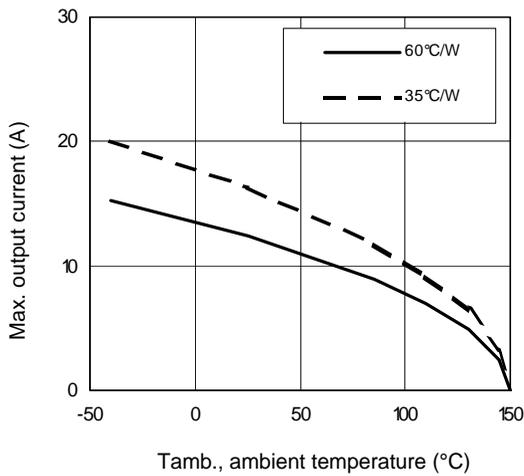
**Figure 12 – Max. iout (A) Vs Tamb. (°C)**
