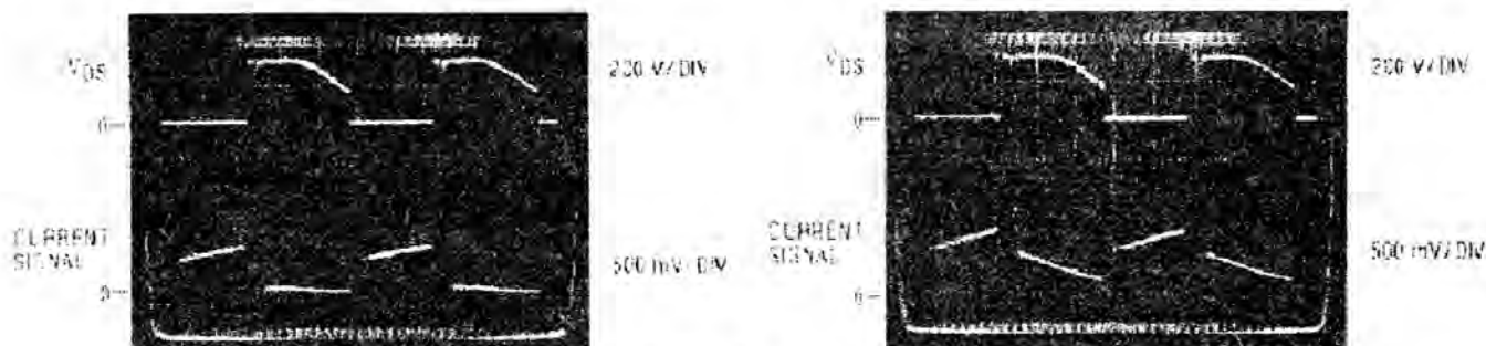
Рис.2. Сигналы считывания тока при полной нагрузке ( I_L = 3.8A )
